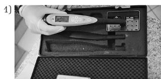
1) Calibración del equipo de fluorescencia láser
